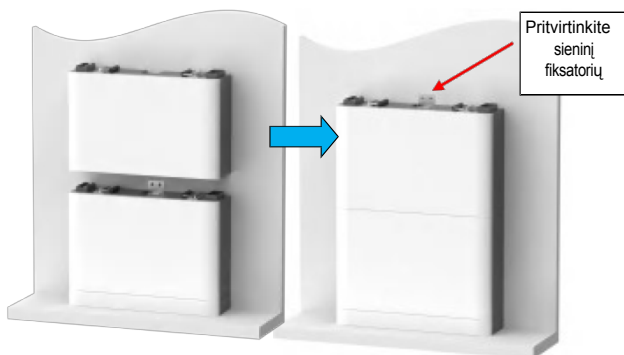
2.5 pav. Akumuliatoriaus modulio montavimas
