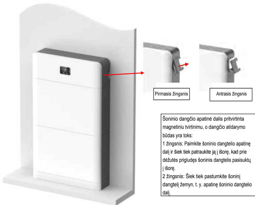
2.7 pav. Šoninio dangtelio nuėmimas ir surinkimas
